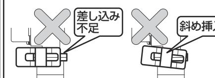
●クイックファスナーが確実に取り付けられているか、ファスナーカバーを取り付けて確認してください。クイックファスナーが正常に取り付けられていない場合、ファスナーカバーが取り付けません。
