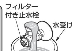
バケツなど水受けとなるものを準備し、壁や床に水が飛び散らないよう止水栓をゆっくり開き、給水管内のごみ、砂などを洗い流す。
